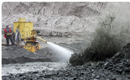
**В настоящее время основные работы ведутся на Приморском карьере, площадь которого составляет 150 га, а глубина залегания янтареносного слоя (голубой глины) – 50-60м. Проектом принята комбинированная (бестранспортно-транспортная) система разработки, вскрыша земли производится уступами:**
